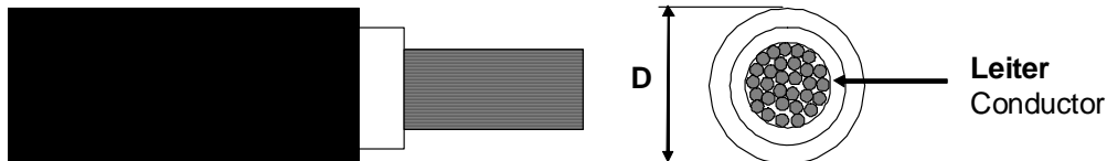
Fig. D Solar cables
